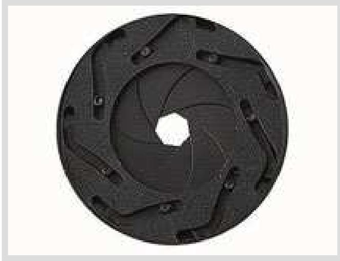
**8. Diaframma** - E' l'elemento interno all'obiettivo attraverso il quale passa la luce che entra nella fotocamera prima di raggiungere il sensore. E' costituito da un insieme di lamelle che vanno a formare un piccolo foro di ampiezza variabile, permettendo di dosare la quantità di luce.
