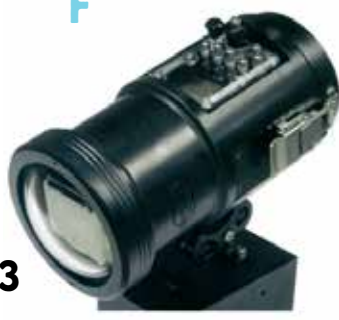
F.1 Flash originale per uso in ambiente aereo. F.2 Custodia con flash alloggiato in posizione a L. F.3 Custodia con flash alloggiato in posizione distesa.
